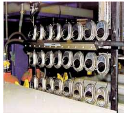
Asciugatura pezzi dopo il lavaggio e sgrassaggio
