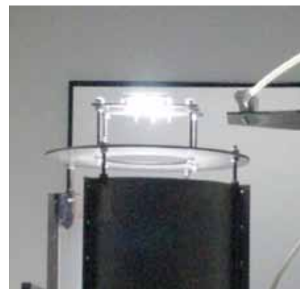
Raffreddamento lampada e filtro per simulatore solare
