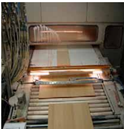
Pulizia pannelli di legno prima della verniciatura
