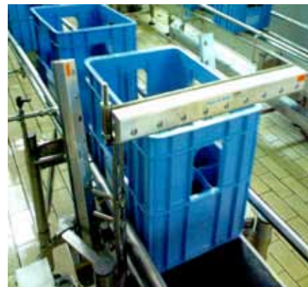
Asciugatura cassette di plastica per acqua minerale
