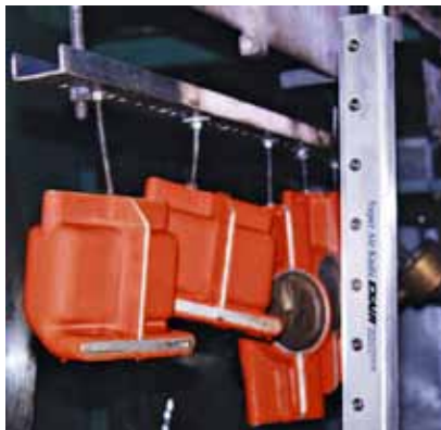
Raffreddamento pezzi rivestiti di plastica
